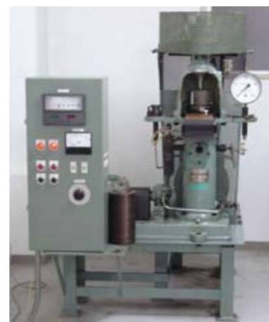
写真 B-14：曾田式四球摩耗試験機 Photo B-14：SOTA-4-Ball wear test machine
